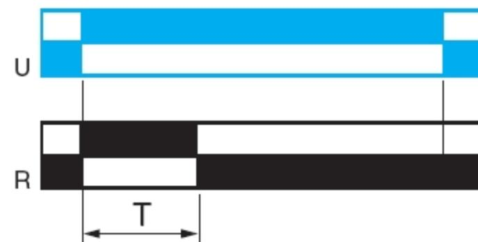
При подаче питания на реле времени начинается отсчет выдержки  $T$  и замыкае(ю)тся выход(ы)  $R$ . По окончании выдержки  $T$  выход(ы)  $R$  возвращае(ю)тся в исходное положение.
